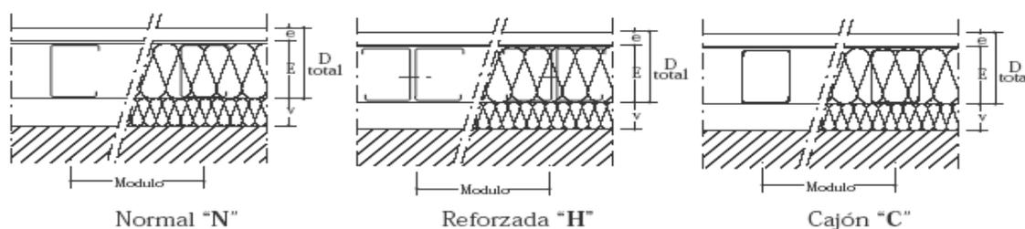
La altura máxima de los sistemas de PYL con estructura metálica portante, depende del ancho de esta, la modulación a ejes de los elementos verticales, configuración de estos (posición normal, reforzada en H o cajón C) y el número de placas de yeso que conformen los paramentos. A continuación se expone a modo de aclaración y ejemplo la manera general de calcular esta característica según el documento francés **DTU 25-41**:
