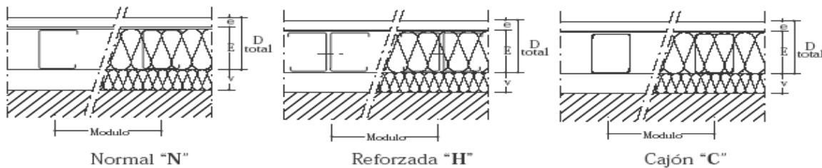
La altura máxima de los sistemas de PYL con estructura metálica portante, depende del ancho de esta, la modulación a ejes de los elementos verticales, configuración de estos (posición normal, reforzada en H o cajón C) y el número de placas de yeso que conformen los paramentos. A continuación se expone a modo de aclaración y ejemplo la manera general de calcular esta característica según el documento francés DTU 25-41:
